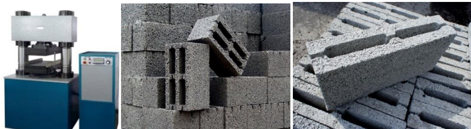
Рис. 1. Пресс ИП-2500 М для испытания керамзитобетонных блоков СКЦ 1Р100 и СКЦ2Р100 и отобранные образцы керамзитобетонных блоков
