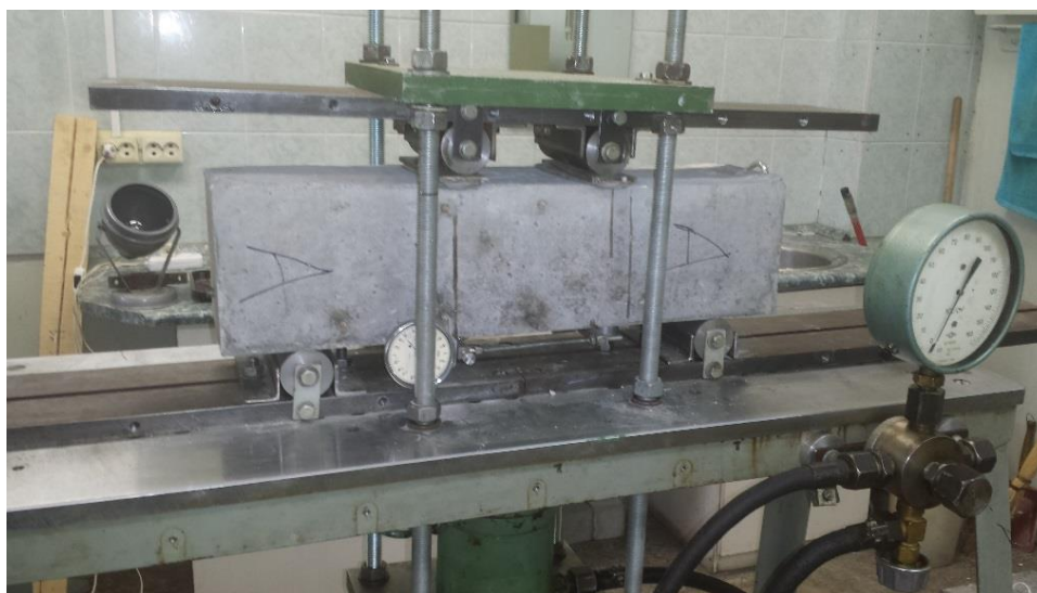
Рис. 4. Испытание образцов-балочек на растяжении при изгибе
